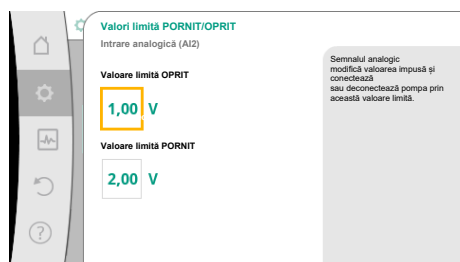
Fig. 80: Valori limită pentru comandă PORNIT/OPRIT prin semnale analogice
