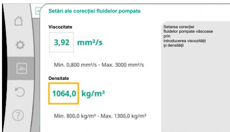
Fig. 97: Reglarea vâscozității și densității
