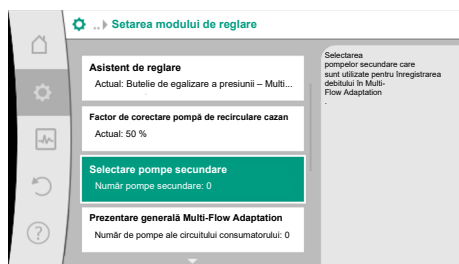
Fig. 57: Asistent de reglare – selectare pompe secundare
