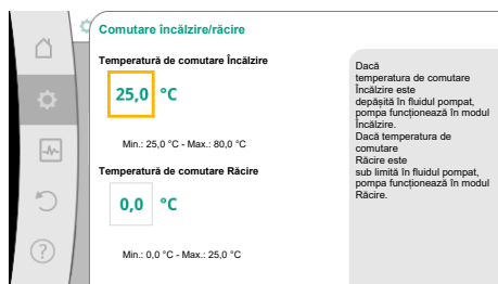
Fig. 51: Comutare încălzire/răcire_Temperaturi de comutare
