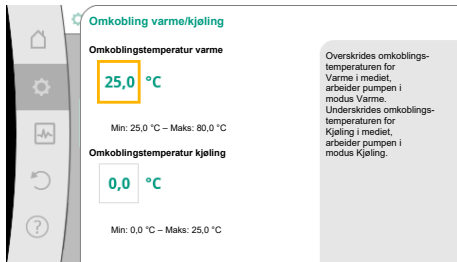
Fig. 51: Omkobling varme/ kjøling_Omkoblingstemperaturer
