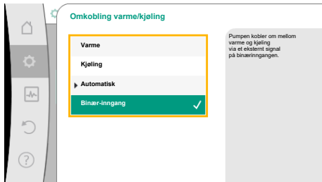
Fig. 52: Omkobling varme/kjøling_Binær- inngang
