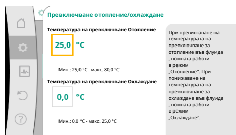
Fig. 51: Превключване отопление/ охлаждане_температури на превключване
