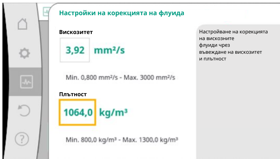
Fig. 97: Регулиране на вискозитета и плътността
