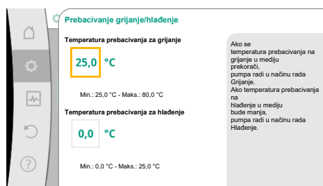
Fig. 51: Prebacivanje grijanje/hlađenje_temperatura prebacivanja
