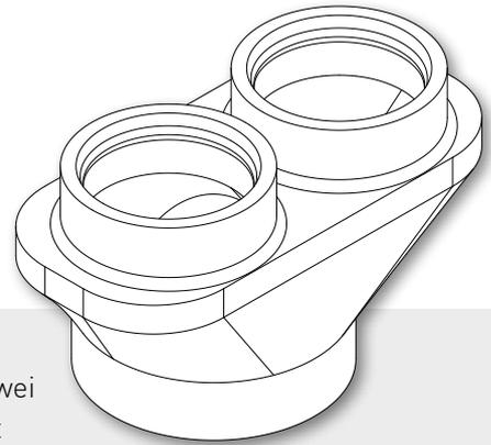
Dieses Teil ermöglicht den Anschluss eines Abluftkanals ( $\varnothing$  160 mm) an zwei Anschlussmündungen ( $\varnothing$  125 mm) der DucoBox Silent und DucoBox Silent Connect. Die Verteilung auf zwei Kanäle verringert den Widerstand, was zu einem leiseren und energiesparenderen Betrieb führt.
