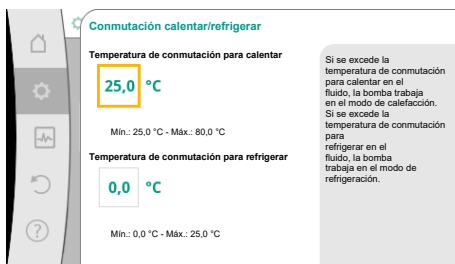
Fig. 51: Conmutación calefacción/refrigeración_Temperaturas de conmutación
