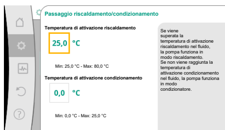
Fig. 51: Passaggio riscaldamento/condizionamento_Temperature di commutazione
