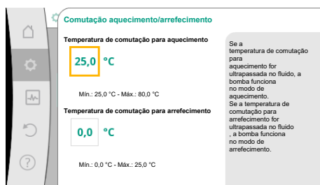
Fig. 51: Comutação aquecimento/arrefecimento_Temperaturas de comutação
