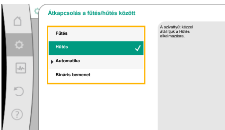
Fig. 49: Átkapcsolás a fűtés/hűtés között_Hűtés
