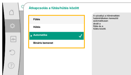
Fig. 50: Átkapcsolás a fűtés/hűtés között_Automatika
