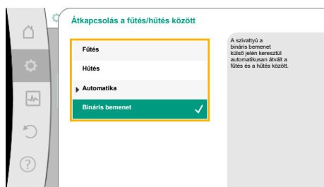
Fig. 52: Átkapcsolás a fűtés/hűtés között_Bináris bemenet
