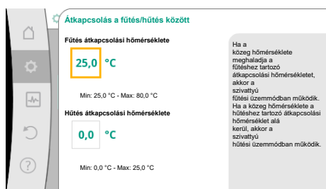
Fig. 51: Átkapcsolás a fűtés/hűtés között_Átkapcsolási hőmérsékletek
