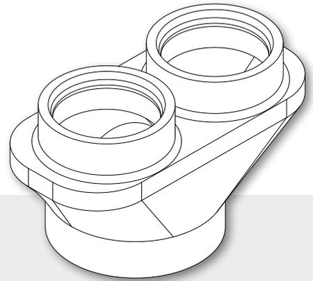
Cette pièce permet de raccorder un canal d'évacuation d'un diamètre de 160 mm sur deux ouvertures de raccordement ( $\varnothing$  125 mm) de la DucoBox Silent et DucoBox Silent Connect. Grâce à la répartition sur deux canaux, la résistance est limitée, offrant par là même un fonctionnement plus silencieux et moins énergivore.
