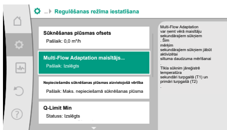
Fig. 59: Regulēšanas režīma iestatīšana: Multi-Flow Adaptation maisītājs
