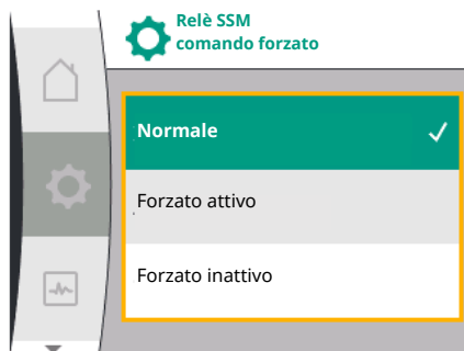
Fig. 32: Comando forzato relè SSM
