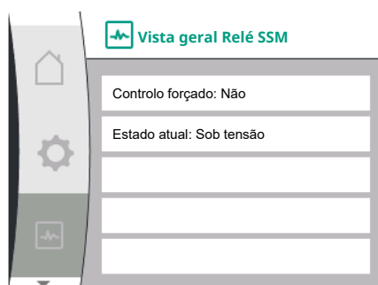
Fig. 42: Vista geral da função de relé SSM
