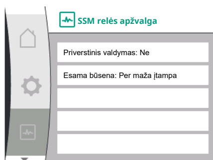
Fig. 42: Relės funkcijos SSM apžvalga
