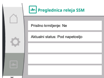
Fig. 42: Preglednica delovanja releja SSM
