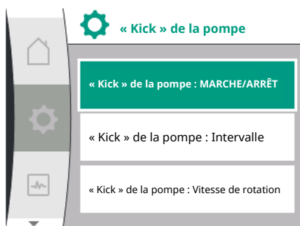
Fig. 40: Réglage du « kick » de la pompe
