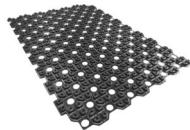
Tiefgezogene, gelochte Matte für eine flache Fußbodenheizung unter Verwendung spezieller Unterlagsmaterialien. Die Matte ermöglicht die Montage eines Nassbodenbelags mit einer Höhe von bis zu 3 cm. Das Fußbodenheizungssystem ist für renovierte Gebäude und andere Gebäude bestimmt, in denen die technischen Bedingungen eine Fußbodenheizung in traditioneller Form nicht zulassen.
