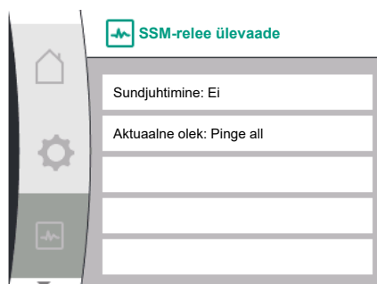
Fig. 93: Releefunktsiooni SSM ülevaade
