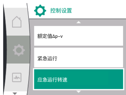
Fig. 73: 控制设置菜单，在传感器值故障的情况下有紧急运行模式
