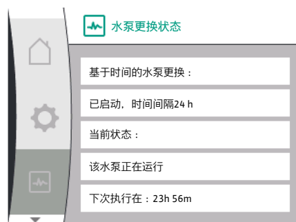
Fig. 97: 水泵更换状态的信息
