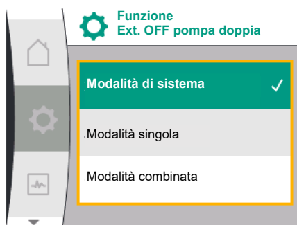
Fig. 68: Modalità selezionabili per EXT. OFF con pompa doppia
