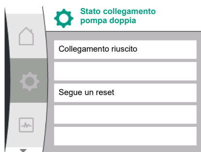
Fig. 51: Collegamento di pompa doppia riuscito
