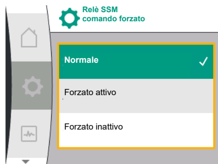
Fig. 62: Comando forzato relè SSM
