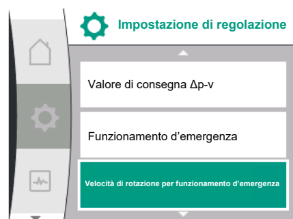
Fig. 73: Menu Impostazioni di regolazione con modalità di funzionamento d'emergenza in caso di mancanza del valore del sensore
