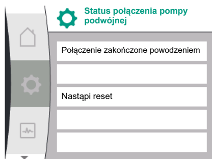
Fig. 51: Połączenie pompy podwójnej zakończone powodzeniem
