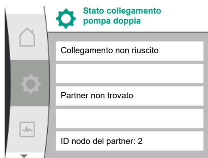
Fig. 52: Collegamento doppio fallito
