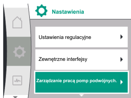
Fig. 48: Menu Zarządzanie pracą pomp podwójnych
