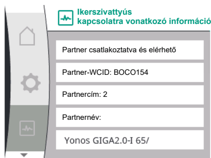
Fig. 96: Ikerszivattyús kapcsolatra vonatkozó információk
