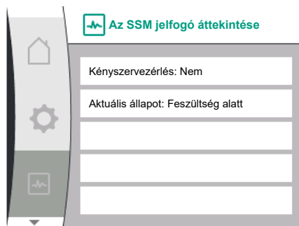
Fig. 93: Az SSM-reléfunkció áttekintése
