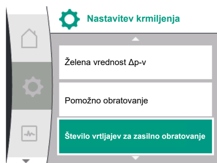
Fig. 73: Meni nastavitve regulacije z načinom pomožnega obratovanja pri izpadu senzorske vrednosti
