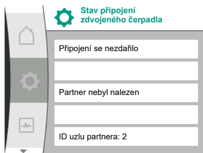
Fig. 52: Neúspěšné připojení zdvojeného čerpadla
