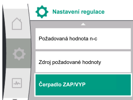
Fig. 46: Nastavení regulace čerpadla ZAP/VYP
