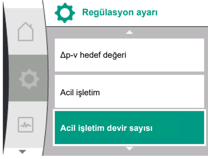
Fig. 73: Sensör değeri hatası durumunda acil işletim modu ile Regülasyon ayarları menüsü
