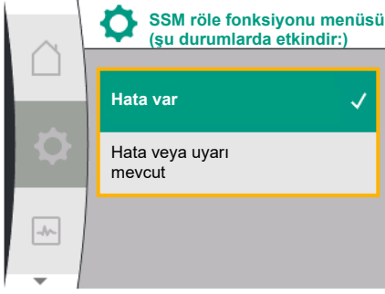
Fig. 60: SSM röle fonksiyonu menüsü
