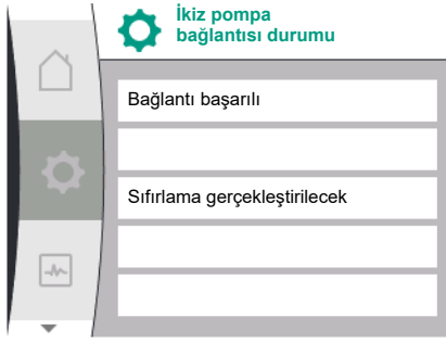
Fig. 51: Başarılı ikiz pompa bağlantısı
