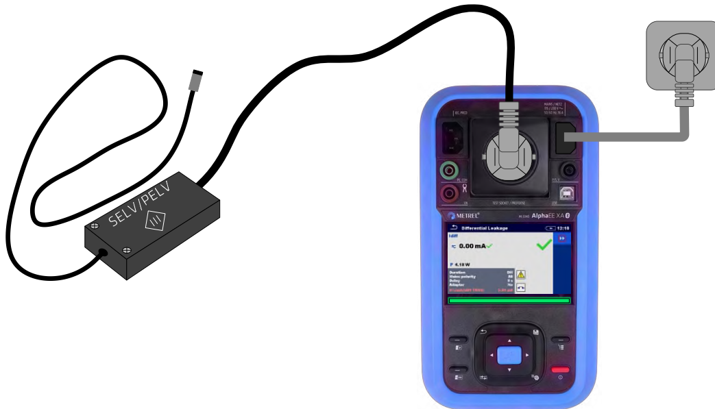
Figuur 195_PE-lekstroom verschilmethode
