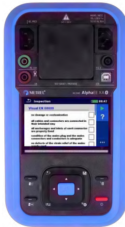
Figuur 53_Visuele inspectie
