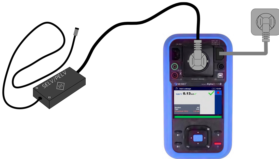
Figuur 197_PE-lekstroom alternatieve methode
