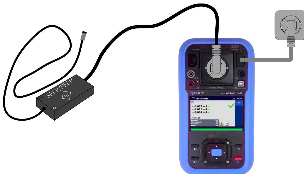
Figuur 193_PE-lekstroom directe methode
