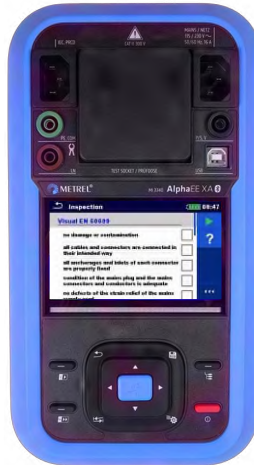
Figuur 116_Visuele inspectie
