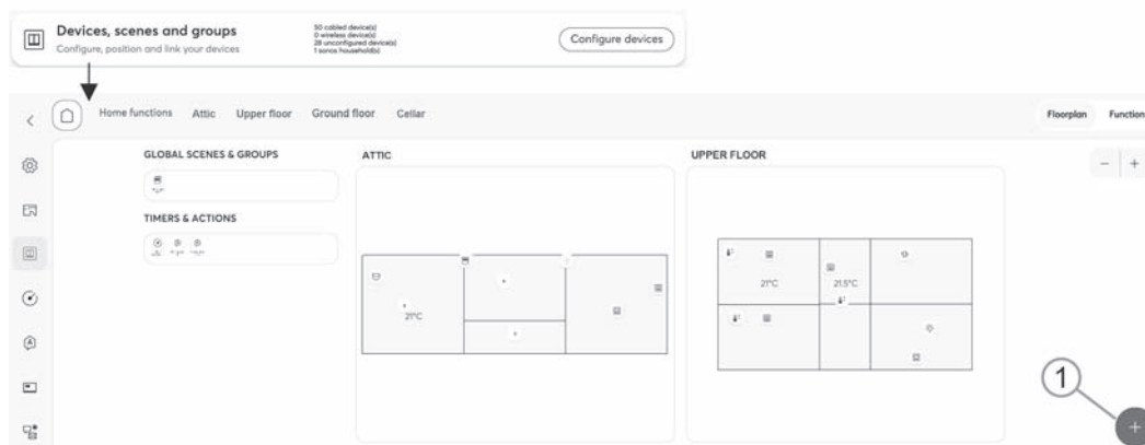
Afb. 23: Gebouwplattegrond en componentenlijst (voorbeeld)
