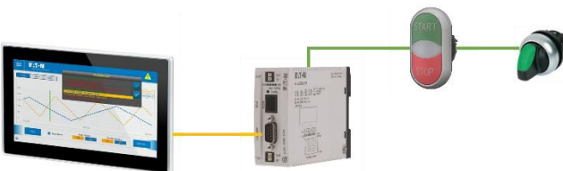
Abbildung 2: Systemaufbau mit Linux Panel, SWD-Gateway und SmartWire-DT-Teilnehmern
