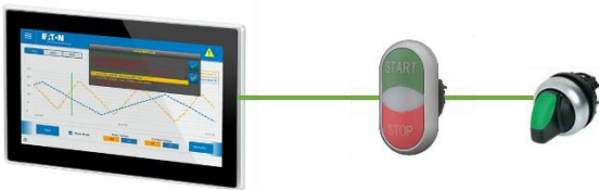
Abbildung 1: Aufbau mit WindowsCE Panel und SWD-Teilnehmern
