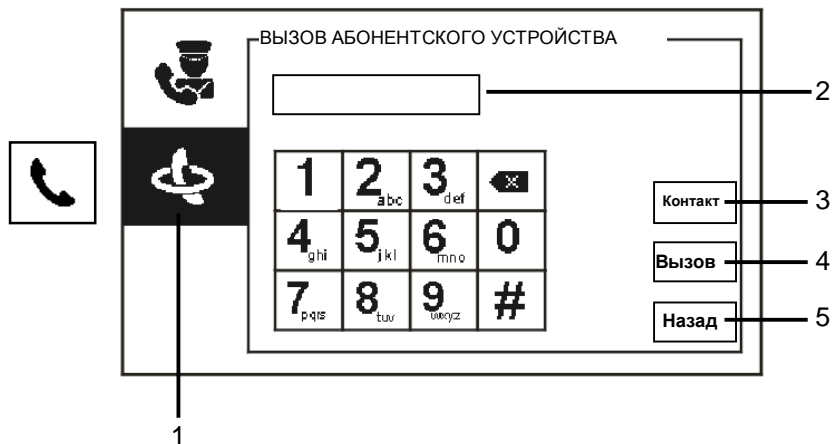
Рис.11. Вызов абонентского устройства
