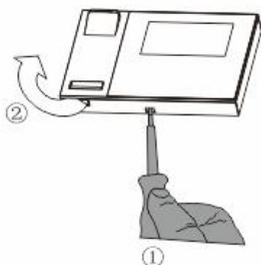
Ouvrir le boîtier en tirant la bride située sur la partie inférieure de l'appareil.
