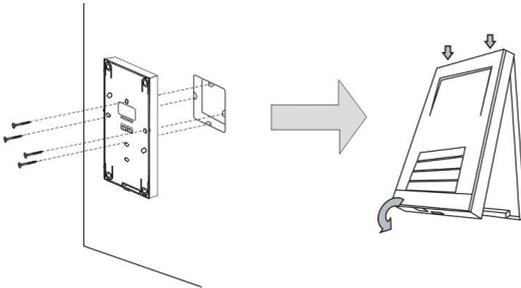
1. Fije la parte inferior del dispositivo a la caja existente de montaje a ras de la superficie.
