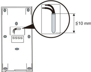
Fije la parte inferior del dispositivo y conéctela siguiendo los gráficos como referencia. La sección aislada del extremo del cable no debe ser más larga de 10 mm.
