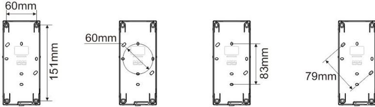
1. La parte inferior del dispositivo cuenta con orificios roscados para fijarlo en la pared, siguiendo las instrucciones anteriores de las dimensiones.
