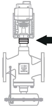
Um die Durchflussmenge zu erhöhen, muss der Einstellring aus seiner niedrigsten Position im Gegenuhrzeigersinn gedreht werden.
