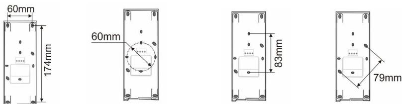
1. Il fondo del dispositivo presenta dei fori filettati per il fissaggio alla parete, delle dimensioni indicate precedentemente.
