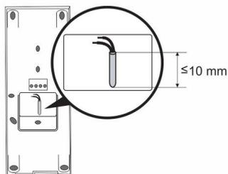
Fissare il fondo del dispositivo e collegarlo come indicato nel grafico. La sezione isolata dell'estremità del cavo non deve essere superiore i 10 mm.
