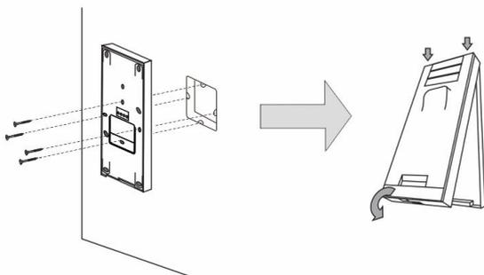
1. Fissare il fondo del dispositivo alla scatola da incasso esistente.
