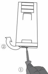
Aprire l'alloggiamento del pannello premendo il gancio sul fondo del dispositivo.
