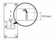
Fije la base del dispositivo y conéctelo con referencia a los gráficos. La sección aislada del final del cable no debe medir más de 10mm.
