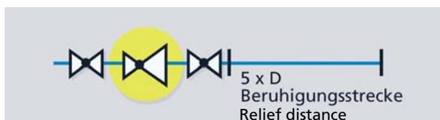
Der werksseitig auf 4 bar Hinterdruck eingestellte Druckminderer ist spannungsfrei in die Rohrleitung einzubauen. Wir empfehlen für Wartungszwecke und zur Druckeinstellung jeweils eingangs- und ausgangsseitig den Einbau eines Absperrventils. Zur Vermeidung von Resonanzschwingungen ist eine Beruhigungsstrecke von 5 x Rohrdurchmesser D einzuhalten. Die Durchflussrichtung muss mit dem Durchflussrichtungspfeil auf dem Gehäuse übereinstimmen.
