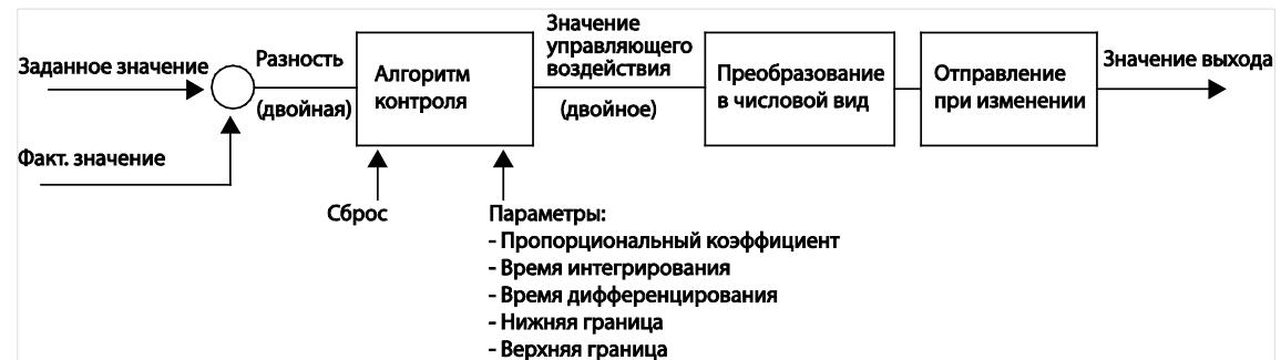
Рис. 20. Схематическое представление регулятора
