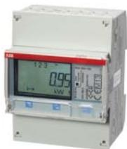
Convertitore collegato CT, 1(6) A. Con valori misurati e funzione di allarme. Per un collegamento a 3 e 4 conduttori. Comunicazione: interfaccia a infrarossi. Interfacce opzionali: M-Bus, RS-485 (Modbus o EQ-Bus configurabili). Larghezza: 2 moduli DIN. Controllato e approvato secondo MID e IEC.
