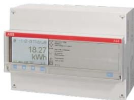
Convertitore collegato CTVT, 1(6) A. Con valori misurati e funzione di allarme. Per un collegamento a 3 e 4 conduttori. Comunicazione: interfaccia a infrarossi. Interfacce opzionali: M-Bus, RS-485 (Modbus o EQ-Bus configurabili). Larghezza: moduli 7 DIN. Controllato e approvato secondo MID e IEC.
