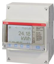
Convertitore collegato CTVT, 1(6) A. Con valori misurati e funzione di allarme. Comunicazione: interfaccia a infrarossi. Interfacce opzionali: M-Bus, RS-485 (Modbus o EQ-Bus configurabili). Larghezza: moduli 4 DIN. Controllato e approvato secondo MID e IEC.
