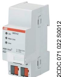
L'accoppiatore di linea LK/S 4.2 con ABB i-bus® KNX è un apparecchio per installazione in serie con larghezza modulare pari a 2 TE. Viene utilizzato come accoppiatore di linea/area o come amplificatore di linea. Come accoppiatore di linea, il LK/S collega una linea ad una linea principale, accoppiatore di area, collega una linea dorsale. In questo caso, realizza un isolamento galvanico.
