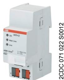
El acoplador de línea LK/S 4.2 ABB i-bus<sup>®</sup> KNX es un aparato para montaje en raíl DIN con anchura de módulo de 2 HP. Se utiliza como acoplador de líneas/zona o como repetidor de líneas. Como acoplador de líneas, el LK/S une una línea con una línea principal; como acoplador de zona, une una línea principal con una línea de zona. De este modo proporciona aislamiento galvánico.
