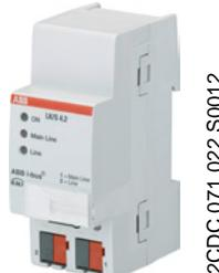
Der ABB i-bus® KNX Linienkoppler LK/S 4.2 ist ein Reiheneinbaugerät mit 2 TE Modulbreite. Er wird als Linien-/Bereichskoppler oder Linienverstärker eingesetzt. Als Linienkoppler verbindet der LK/S eine Linie mit einer Hauptlinie, als Bereichskoppler eine Hauptlinie mit einer Bereichslinie. Hierbei sorgt er für eine galvanische Trennung
