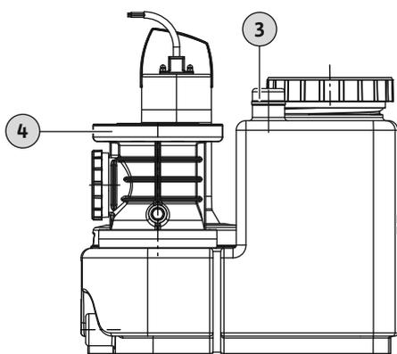
Fig. 6: Ligação de ventilação do tanque coletor
