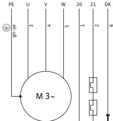
Fig. 7: Esquema de conexión motor 3~: Arranque directo, sensor bimetalítico
