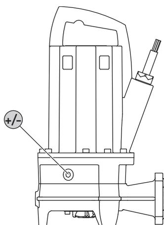
Fig. 9: Cámara de separación: Cambio de aceite
