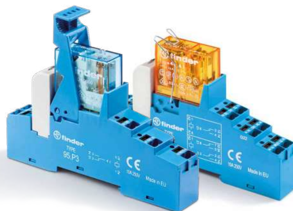
Type 48.P3 1 wisselcontact 10 A 250 V AC1
