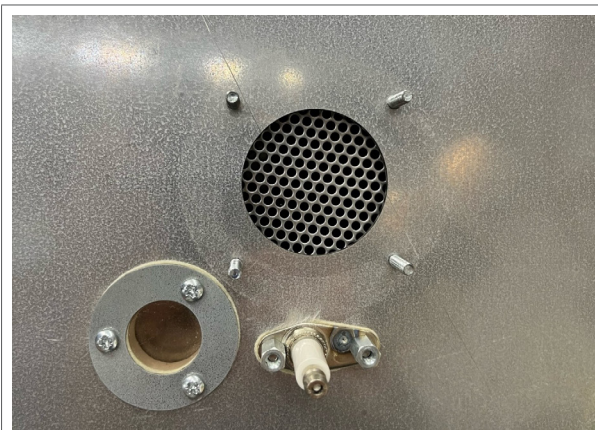
Figuur 26 - Het rooster voor de brander
