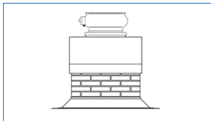
Dakventilator, geluiddemper, bouwkundige opstand
