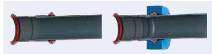
Fig. 1 coupe transversale avant et après le sertissage
