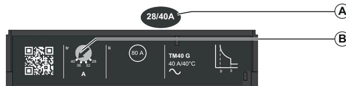
**A** Rango de ajuste para la unidad de control magnetotérmica TM-G
