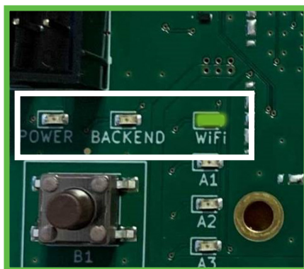
La estación BCSD Smart se ha conectado correctamente con la WIFI pero no a Internet.
