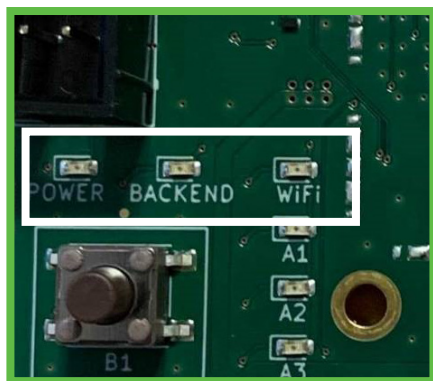
La estación BCSD Smart no se puede conectar a la WIFI elegida.
