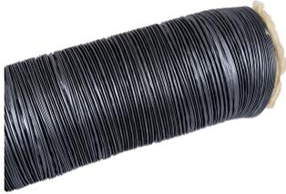
Flebibles Rohr für den Einsatz der Brauchwasserwärmepumpe WHP mit Aussenluftzufuhr, Länge 6m, inkl. Wärmedämmung und Alu-Innenbeschichtung
