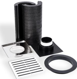
Außenwanddurchführung mit Wetterschutzgitter, Insekteneschutzgitter und Dämmhülsen für das Luftverteilsystem der Brauchwasserwärmepumpe WHP, für Wandstärken von 300 bis 600mm, Wärmebrückenfrei durch EPP-Rohrhülse Durchmesser 200mm Innen und Durchmesser 300mm Außen
