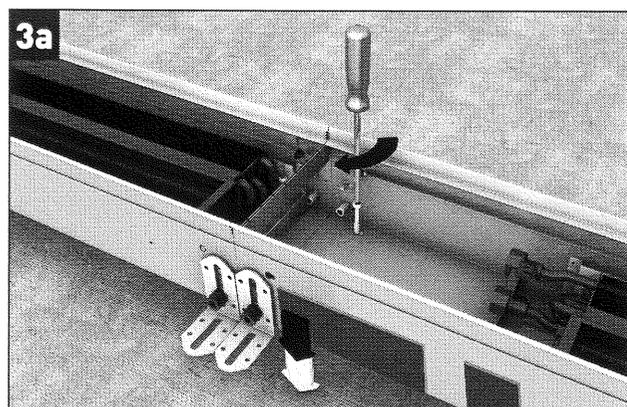
Gebruik de regelschroeven om de Clima Canal op de gewenste hoogte te zetten **(3a)**.
