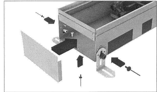
**2** Kanalen doorverbinden / Connexion des canaux / Verbindung von Kanälen / Connexion of canals
