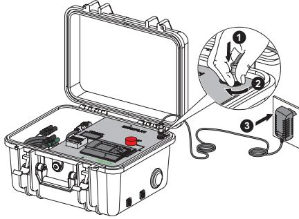
MFL connecté au réseau par une entrée de tension : / Das MFL ist über den Spannungseingang am Netz angeschlossen: / MFL collegato al sistema mediante l'ingresso di tensione: / MFL подключен к системе через сеть:
