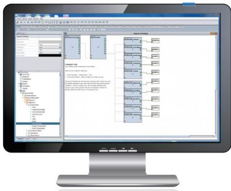
Con el lenguaje de programación por bloques de próxima generación ViPR (Visual Programming Resource) de Cylon Auto-Matrix, puede obtenerse cualquier esquema de control sencillamente enlazando bloques mediante un método basado en los flujos. Este enfoque permite incluso a los programadores principiantes diseñar aplicaciones sin tener que escribir y depurar programación de líneas de código.
